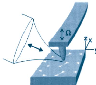
Figure 2.6. Apertureless NSOM probe (courtesy of F. Keilmann, Max Planck Institut für Biochemie).
